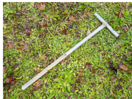
Bodenproben lassen sich am einfachsten mit einem Bohrstock ziehen.
