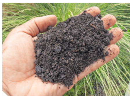
Mineralische Deckschicht: Lavagranulat oder Splitt. Unten: Dachgartensubstrat mit Kompost.
