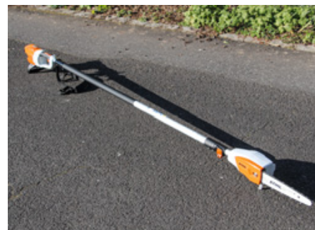
Mit dem Hochentaster erreicht man Arbeitshöhen über 5 m.
