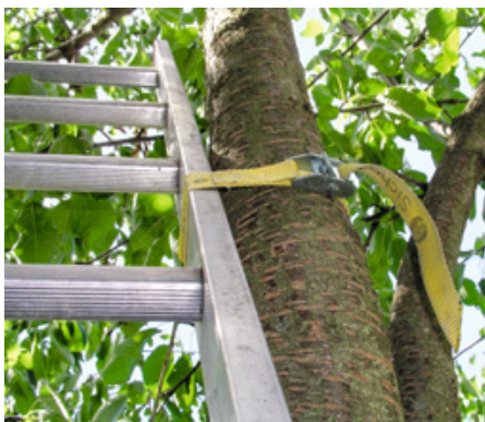
Zurrgurte sichern Anlegeleitern gegen seitliches Wegrutschen.
