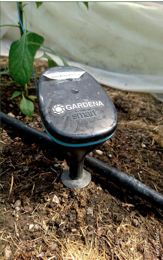
Ein „Smart-Sensor“ misst Bodenfeuchte, Lichtstärke und Außentemperatur per App und kann in die Bewässerungssteuerung integriert werden.
