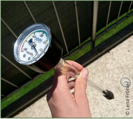
Tensiometer zur Messung der Bodenwasserspannung
